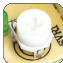
Возможность корректировки выходного напряжения
