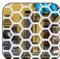
Вентиляционные отверстия для луч- шего теплоотвода
