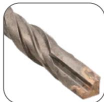
Голова бура закреплена на шнеке не пайкой, а диффузионной сваркой для лучшей износостойкости бура
