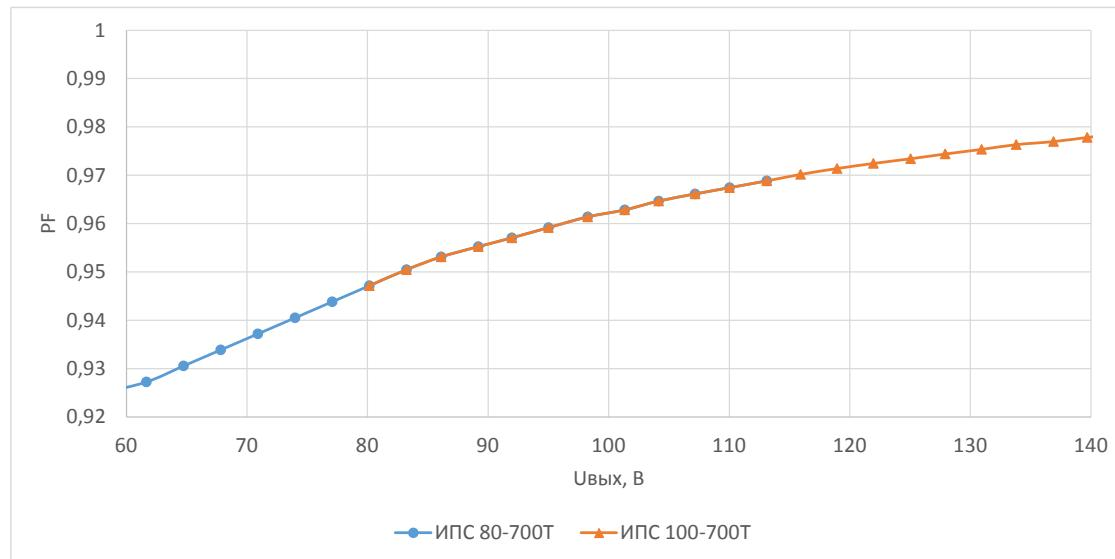
Все параметры измерены при напряжении питания 220В АС и номинальной нагрузке при 25° С окружающей среды.
