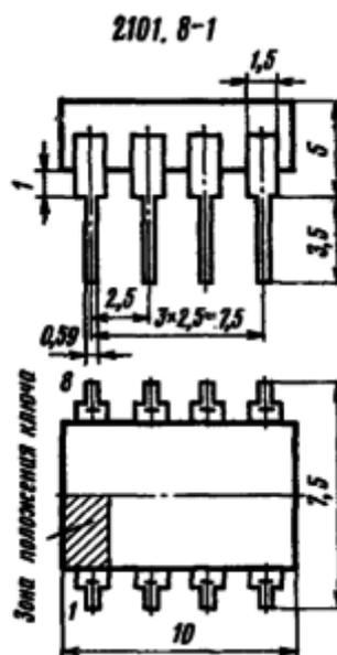
Микросхемы представляют собой высоковольтный однонаправленный токовый ключ с низким остаточным сопротивлением. Предназначены для коммутации цепей до 100 мА в аппаратуре автоматики и связи. Согласуются по уровню управляющих сигналов с КМОП схемами. Содержат 2 интегральных элемента. Корпус типа 2101.8-1.
