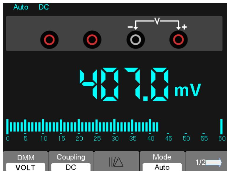
Рисунок 7-6 Измерение напряжения постоянного тока
