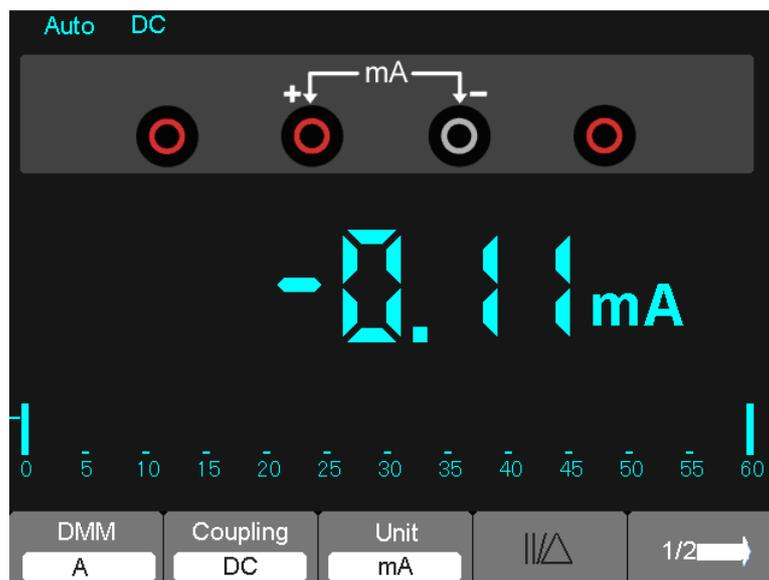
Рисунок 7-8 Измерение тока для силы тока менее 600 мА
