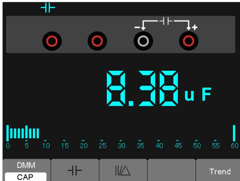
Рисунок 7-5 Измерение емкости
