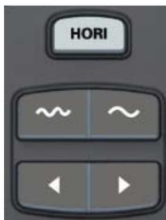
**1. ПОЛОСА ГОРИЗОНТАЛЬНОГО ПОЛОЖЕНИЯ:** Используется для управления положением триггера в центре экрана.
