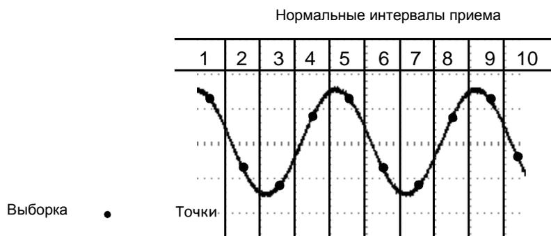
В режиме Normal режим одна точка выборки принимается в каждом интервале
