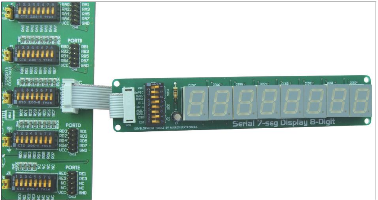
Рисунок 3: Подключение дополнительной платы Serial 7-seg 8-Digit Board к отладочной системе
