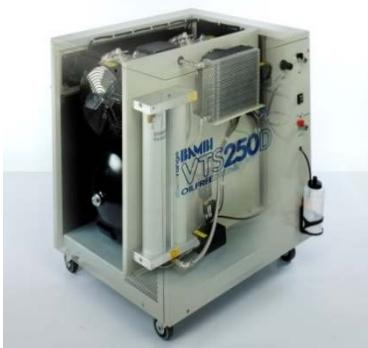
В тех случаях, когда компрессор высокой производительности должен быть установлен вблизи оператора, рекомендуется серия VTS. Модели этой серии построены на базе компрессоров VT, но снабжены кожухом, значительно снижающим уровень шума и позволяющим лучше вписать устройство в интерьер лаборатории или рабочего места.
