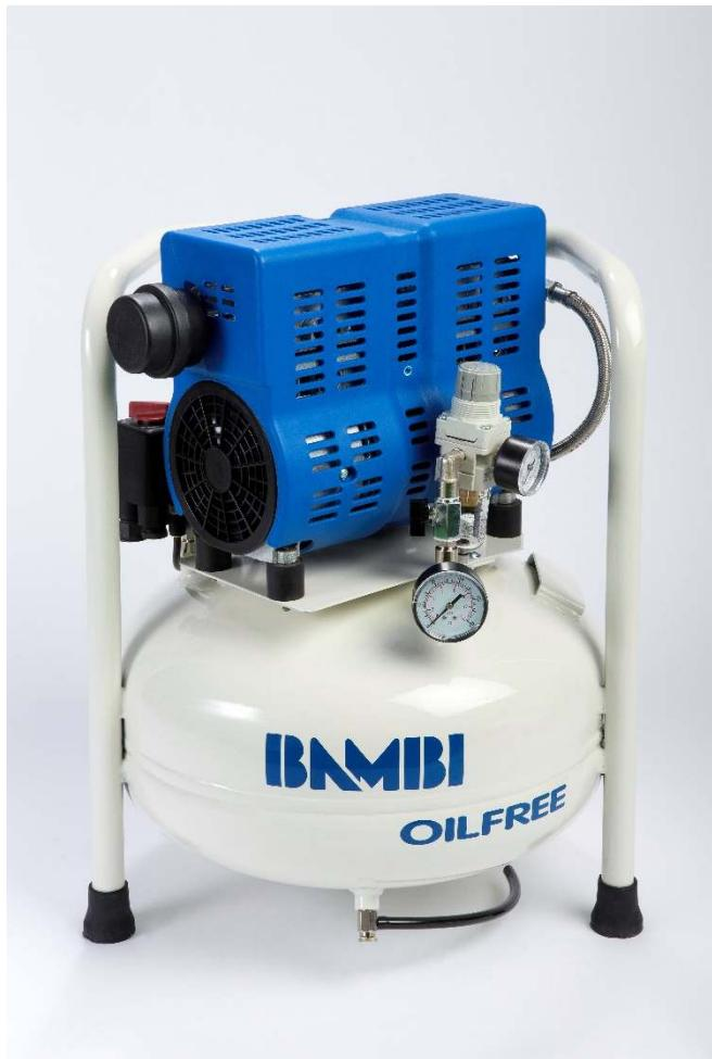
После 40 лет передовых разработок в области компрессоров, BAMBI представили новую линейку бесшумных безмасляных компрессоров серии РТ. Новые помпы обладают невероятно низким уровнем шума всего в 54дБ и качают 100% чистый от масла сжатый воздух в ресивер. В линейке присутствуют различные комбинации ресиверов и помпы для наиболее полного охвата всех задач.
