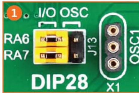
Рисунок 4-6: RA6 и RA7 как порты ввода / вывода (при использовании внутреннего генератора)
