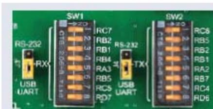
Для USB-UART связи, необходимо установить **J3** и **J4** перемычки в положение **USB-UART**, чтобы включить нужные **RX** и **TX** линии через **SW1** и **SW2** DIP переключатели.
