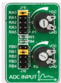
Рисунок 17-1: Использование **J15** и **J16** переключек для подключения линий аналоговых входов с потенциометрами **P1** и **P2**
