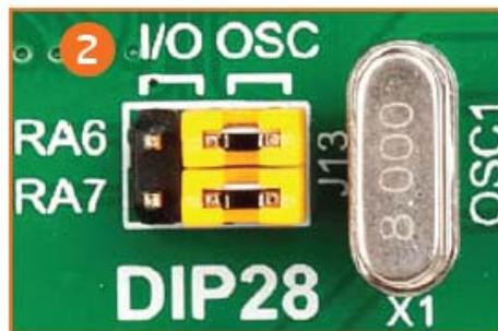
Рисунок 4-7: RA6 и Ra7 подключенные к X1 генератору
