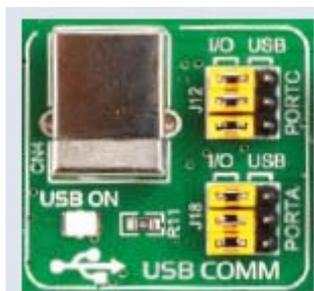
Рисунок 8-1: функция USB отключена
