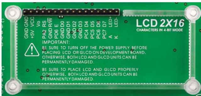
Жидкокристаллические дисплеи или ЖК-дисплеи популярны для конечного пользователя электронного устройства. Плата EasyPICV7 снабжена разъемом и необходимым интерфейсом для поддержки ЖК-дисплеев 2x16 характеристики в 4-битном режиме. Этот тип дисплея имеет в два ряда, состоящего из 16 полей символов. Каждое поле
