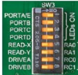
Рисунок 10-7: SW3.1 через SW3.4 переключатели используются для включения светодиодов порта
