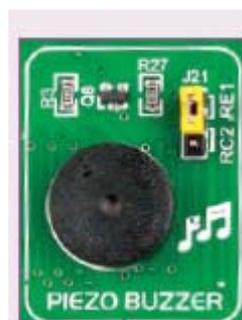
Рисунок 19-2: используйте переключку **J21** для соединения пьезозуммера с **RC2** или **RE1** выводами
