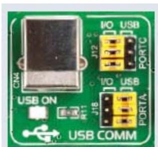
Рисунок 8-3: USB включен на PORTA
