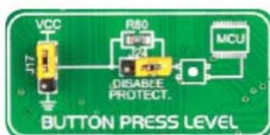
Рисунок 10-6: Использование J17 перемычки определяет уровень нажатия кнопок порта. Используйте J24, чтобы отключить защитный резистор
