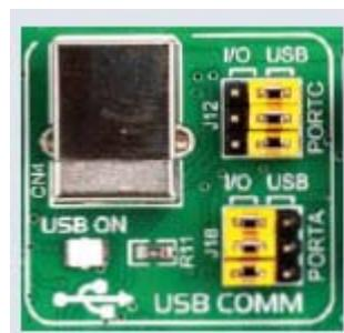
Рисунок 8-2: USB включен на PORTC
