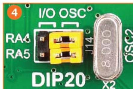
Рисунок 4-9: RA4 и RA5 подключенные к X1 осциллятору
