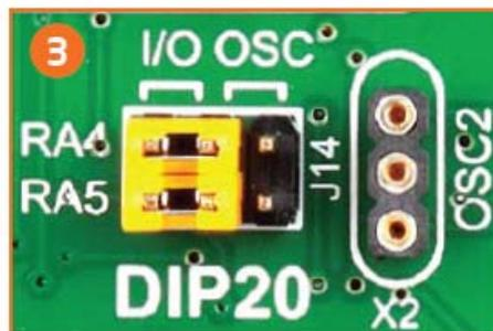
Рисунок 4-8: RA4 и RA5 как порты ввода / вывода (при использовании внутреннего генератора)
