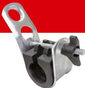
Зажимы промежуточные PS425, PS435, PS450, PS470 используются для крепления двух или четырех проводов и обеспечивают подвеску на промежуточных опорах с углом поворота до 30°. Зажимы снабжены гайкой-барашком.
