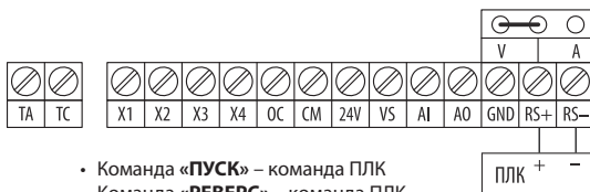
Рисунок 38 - подача команд «Пуск/Стоп» по интерфейсу RS485
