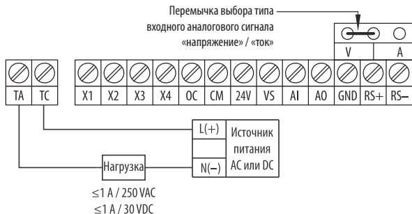
Рисунок 25 – схема подключения нагрузки к релейному выходу (питание от внешнего источника питания постоянного или переменного тока).
