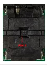
Figure 9. Orientation of the DS28E39 and DS2476 in the Burn-In Socket
