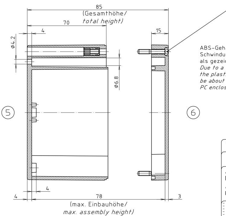
ABS-Gehäuse können durch eine andere Schwindung ca. 0,1-0,25% größer sein als gezeichnete PC-Gehäuse/
