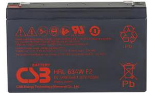
HRL 634W - батарея с высокой энергоемкостью. Особенная кристаллическая решетка электродов позволила увеличить на 20% отдаваемую мощность по сравнению с батареями других серий. Она разработана для эксплуатации в режиме высоких токов разряда при коротком времени разряда. Срок службы: более 8 лет в буферном режиме (10/12 лет при 20°C по классификации Eurobat) или более 260 циклов заряда-разряда в циклическом режиме при 100% разряде.
