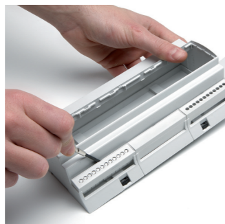
Rimuovere i coprimorsetti Remove the terminal covers
