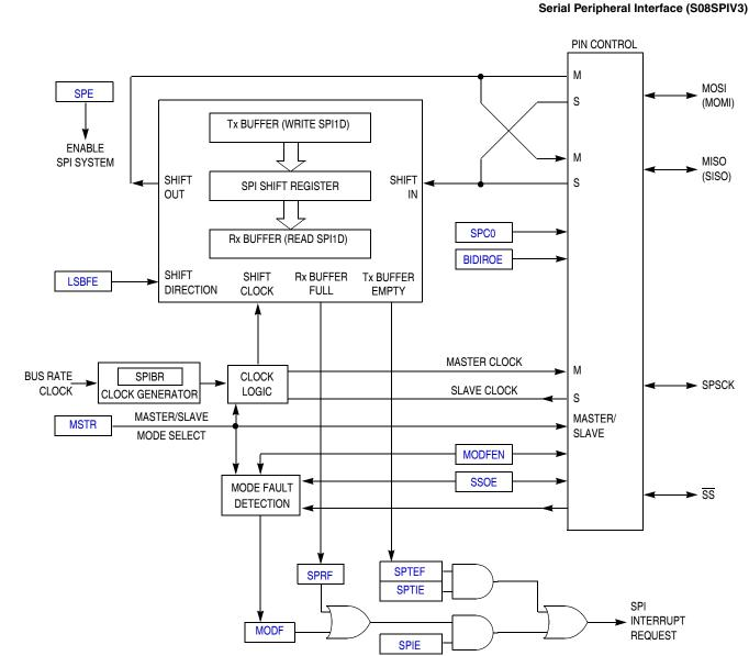
Figure 12-3. SPI Module Block Diagram
