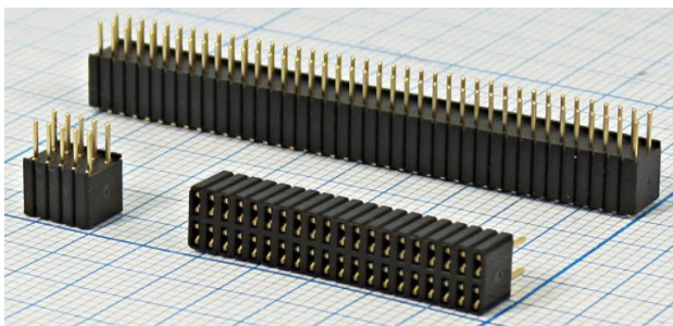
Q-9006 гнездо PBL-2x40 шаг P1,27x2,54мм 80P контактов (2ряда по 40шт), на плату
