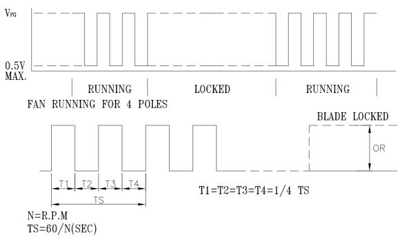
\*VOLTAGE LEVEL AFTER BLADE LOCKED
