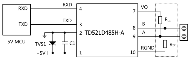
图 1.MCU 5V 供电应用电路
