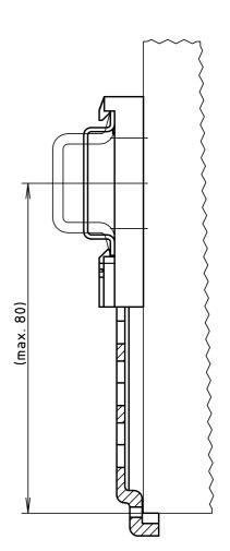
Betätigungsriegel montiert in Rastposition 4/ release lever installed in locking position 1
