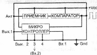
Рис.2 Структурная схема приемника
