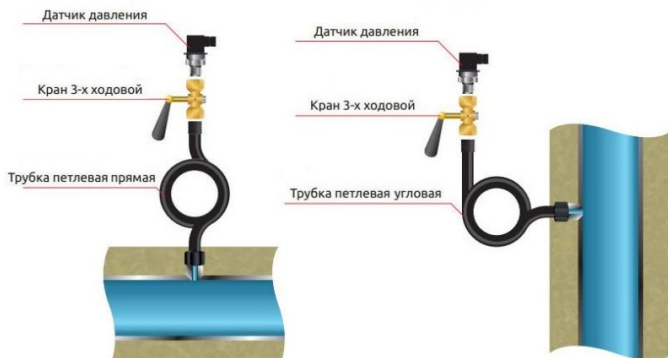
Рисунок 2 – Варианты монтажа на объекте
