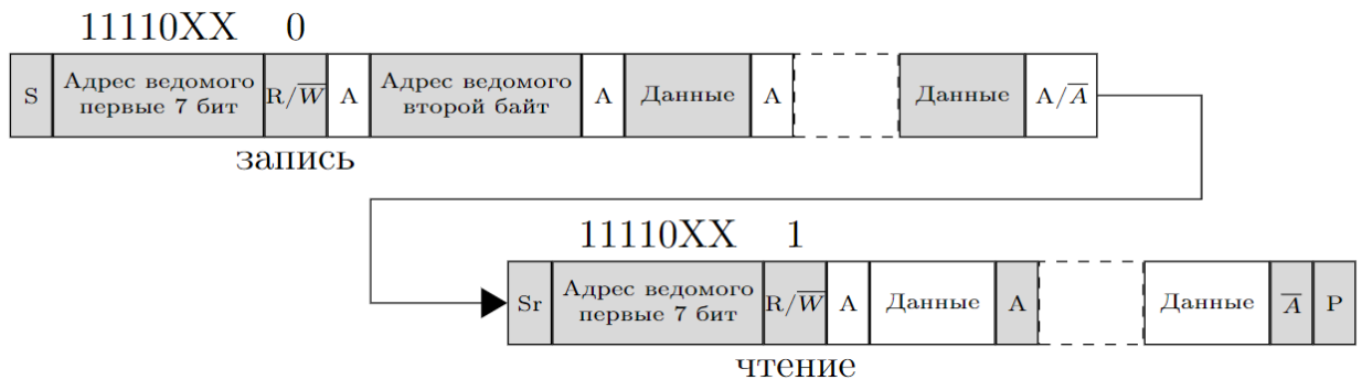
Рисунок 38 – Адресация ведомого 10 бит адреса при HEAD10R=1
