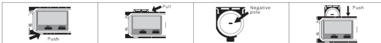
1. Чтобы заменить батарею, нажмите на защитный кожух в нижней части экрана. Край батареи не выходит за верхнюю часть экрана.
