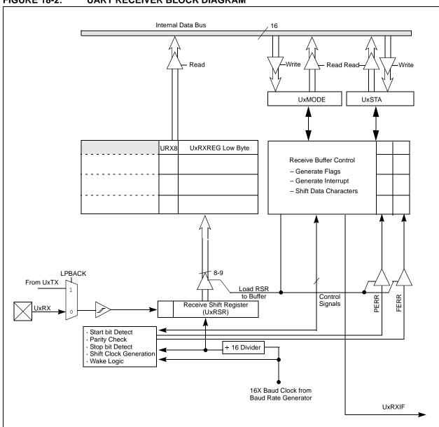
FIGURE 18-2: UART RECEIVER BLOCK DIAGRAM
