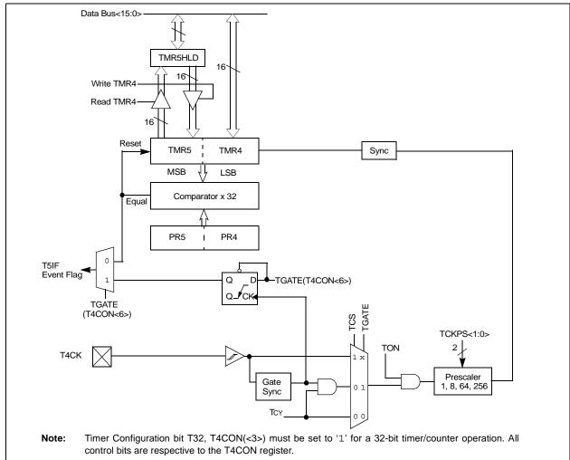
FIGURE 11-2: 16-BIT TIMER4 BLOCK DIAGRAM (TYPE B TIMER)
