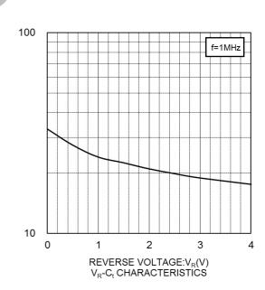
CAPACITANCE BETWEEN TERMINALS:C<sub>f</sub>(pF)
