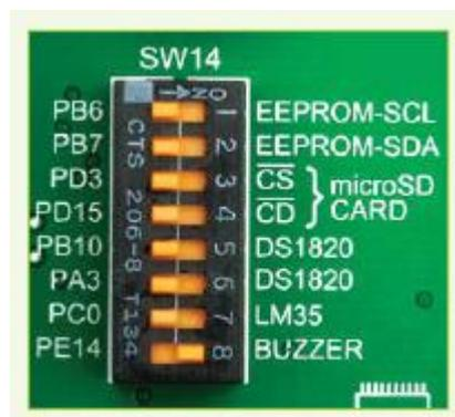
Рисунок 25-2: Переключатель SW14.8 в положении ON для подключения драйвера Пьезозуммера с **PE14** выводом
