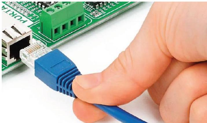
Особенностью платы EasyMx Pro v7 for STM32 является стандартный разъем **RJ-45**, который позволяет микроконтроллеру, что поддерживает связь Ethernet, установить соединение с компьютером, маршрутизатором или другими устройствами.
