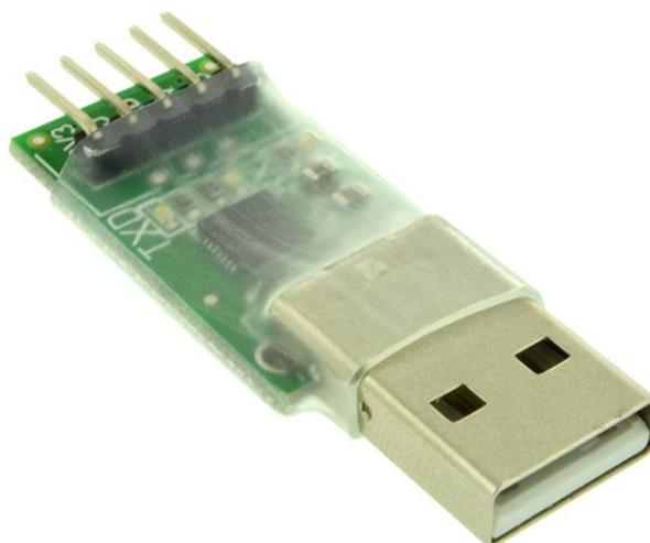
Преобразователь USB-UART позволяет подключить к USB порту компьютера устройства с интерфейсом UART. При подключении в операционной системе создается виртуальный COM-порт, после чего работать с ним можно как с обычным COM-портом.
