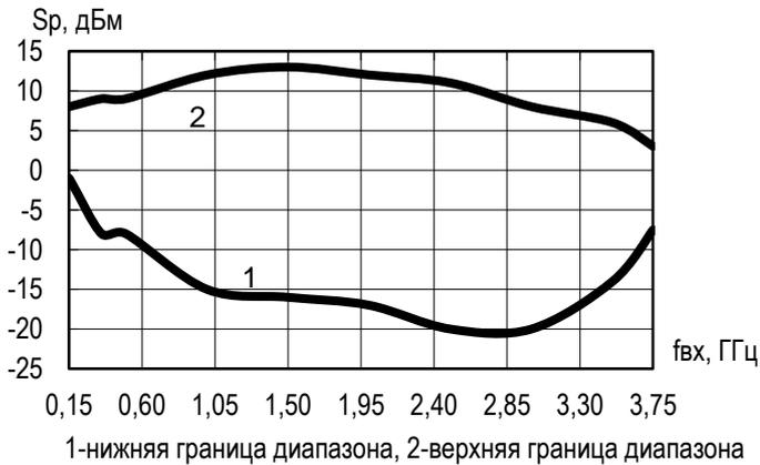
**Зависимость мощности основной гармоники выходного сигнала от частоты входного сигнала ( $U_{п} = 5 В, P_{вх} = 0 дБм$ )**
