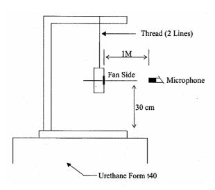
1 METER FROM MICROPHONE TO FAN INTAKE
