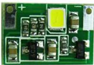
Стробоскоп светодиодный - это модуль состоящий из платы с ярким светодиодом. Стробоскопы применяются в различных областях. Для декорации витрин и привлечения внимания покупателей, в рекламных конструкциях, в клубах, на дискотеках и т.д. и т.д. Светодиодные стробоскопы отличаются малыми размерами, надежностью, низким энергопотреблением, низким напряжением питания, высокой яркостью вспышки и продолжительным ресурсом работы.
