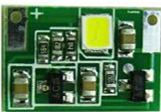
Стробоскоп светодиодный - это модуль состоящий из платы с ярким светодиодом. Стробоскопы применяются в различных областях. Для декорации витрин и привлечения внимания покупателей, в рекламных конструкциях, в клубах, на дискотеках и т.д. и т.д.
