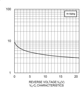
CAPACITANCE BETWEEN TERMINALS:C<sub>t</sub>(pF)
