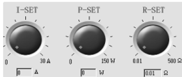
Bild 2-7 Einstellendrehknopf für Strom, Leistung und Widerstand
