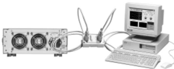
Bild 1-1 Schließen Sie die elektronische Last an den PC an
