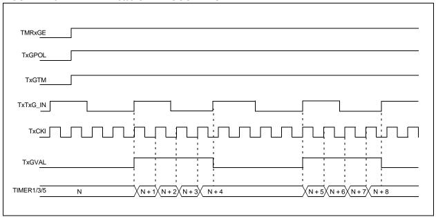
FIGURE 12-6: TIMER1/3/5 GATE SINGLE-PULSE MODE
