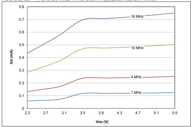
FIGURE 28-63: PIC18F2X/4XK22 MAXIMUM IDD: PRI\_IDLE EC MEDIUM POWER
