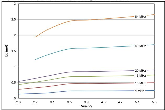
FIGURE 28-67: PIC18F2X/4XK22 MAXIMUM IDD: PRI\_IDLE EC HIGH POWER
