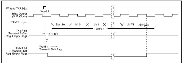
FIGURE 16-4: ASYNCHRONOUS TRANSMISSION (BACK-TO-BACK)
