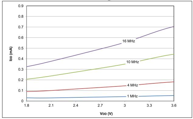
FIGURE 28-61: PIC18LF2X/4XK22 MAXIMUM IDD: PRI\_IDLE EC MEDIUM POWER
