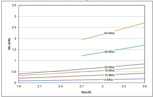
FIGURE 28-65: PIC18LF2X/4XK22 MAXIMUM IDD: PRI\_IDLE EC HIGH POWER
