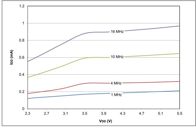
FIGURE 28-64: PIC18LF2X/4XK22 TYPICAL IDD: PRI\_IDLE EC HIGH POWER
