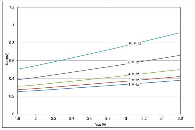
FIGURE 28-41: PIC18LF2X/4XK22 MAXIMUM IDD: RC\_IDLE HF-INTOSC
