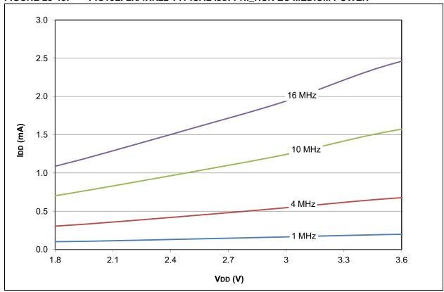
FIGURE 28-49: PIC18LF2X/4XK22 MAXIMUM IDD: PRI\_RUN EC MEDIUM POWER
