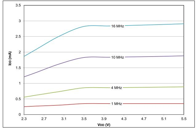
FIGURE 28-52: PIC18LF2X/4XK22 TYPICAL IDD: PRI\_RUN EC HIGH POWER
