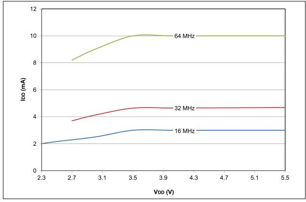
FIGURE 28-60: PIC18LF2X/4XK22 TYPICAL IDD: PRI\_IDLE EC MEDIUM POWER
