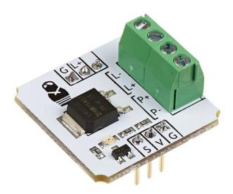
Если в вашем проекте нужно замыкать и размыкать цепь с большим постоянным напряжением или током, силовой ключ из линейки Troyka-модулей — то, что вам нужно. Вам не придётся возиться с пайкой, макетной платой и необходимой обвязкой для работы полевого транзистора — всё уже готово.
