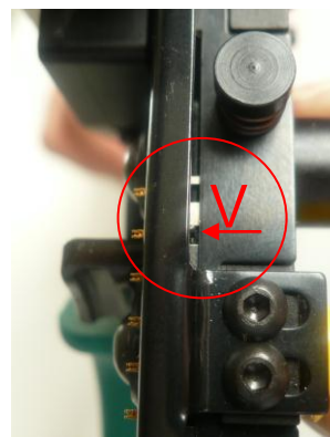
The feed pin engages with strip lock. Der Vorschubstift rastet mit der Kontaktstreifenverriegelung ein.
