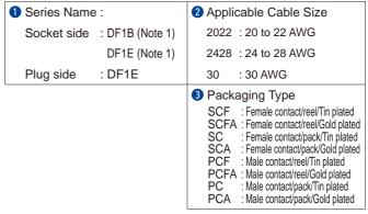
Note 1: When the retainer is used, use DF1E-2022SC(F)(A), DF1B-2428SC(F)(A), and DF1B-30SC(F)(A) contacts. When no retainer is used, all DF1B-\*\*SC(F)(A) and DF1E-2022SC(F)(A) contacts can be used.
