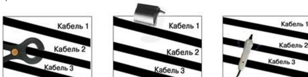
Рисунок А.1 Выбор кабеля из пучка внешними датчиками.
