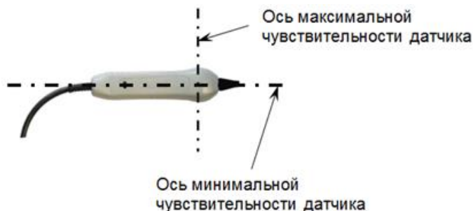
Рисунок А.2 Оси чувствительности датчика ЭМД-127.
