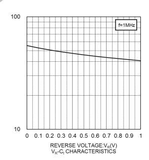
CAPACITANCE BETWEEN TERMINALS:C<sub>(</sub>(pF)
