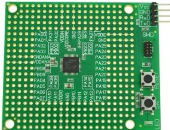
Модуль Evolution light SAM на базе микроконтроллера Atmel SAMD20G16
