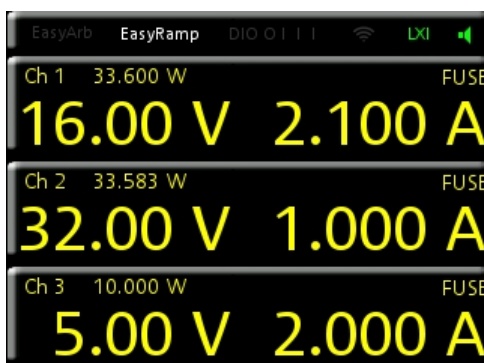
Рисунок 5-11 – Функция электронного предохранителя, включенная для соответствующего канала
