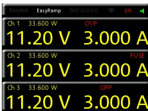
Рисунок 5-13 – Индикатор OVP/OPP при срабатывании защиты
