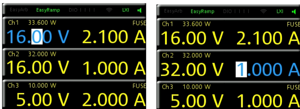
Рисунок 5-10 – Установка напряжения и тока в приборе
