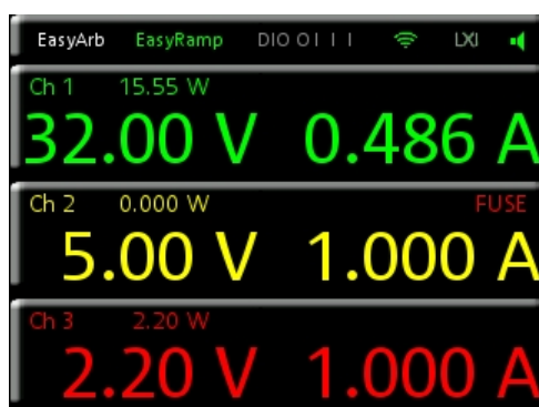
Рисунок 5-1 – Компоновка экрана прибора R&S NGE100
