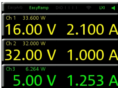
Рисунок 5-12 – Выход канала Ch 3 в режиме стабилизации напряжения CV
