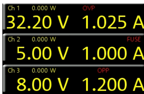
Рисунок 5-2 – Область отображения каналов прибора NGE103
