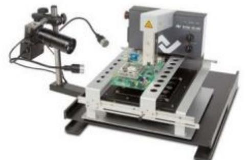
HR 200 с видеокамерой мониторинга пайки
