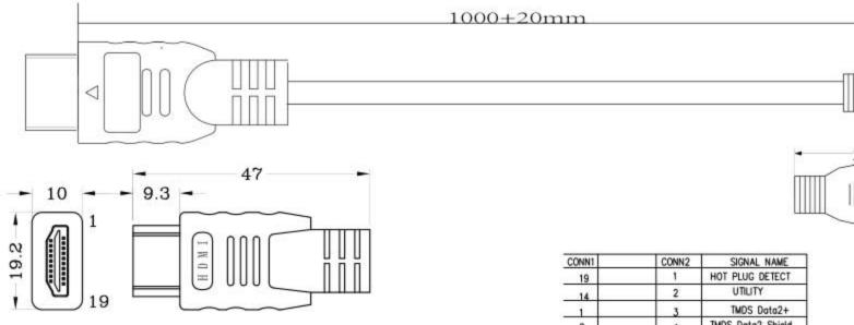
测试参数: 绝缘阻抗: 5M 导通阻抗: 100Ω
