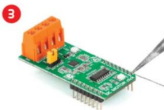
3 После того как вы припаяли выводы, плата готова для размещения необходимого mikroBUS™ гнезда. Убедитесь в том, что Вы выровняли выемку в правой нижней части платы относительно маркировки на шелкографии гнезда mikroBUS™. Если все контакты совмещены правильно, вставьте плату полностью в гнездо.
