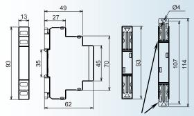
Положение замков для крепления на ровную поверхность
