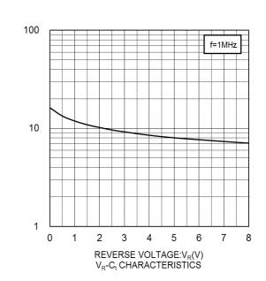
CAPACITANCE BETWEEN TERMINALS:C<sub>t</sub>(pF)
