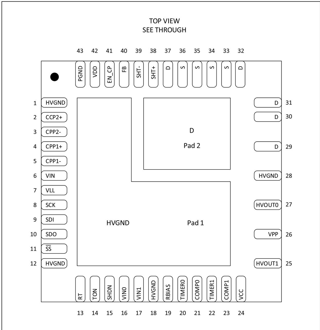
**FIGURE 3-1:** VQFN 43-Lead 7 x 7 mm.
