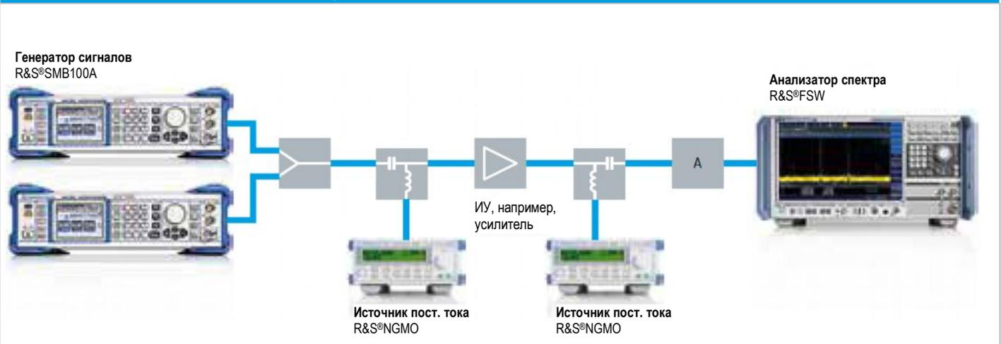
Измерительная установка состоит из двух генераторов сигналов R&S®SMB100A, анализатора спектра и сигналов R&S®FSW для отображения результатов измерения и двух источников постоянного тока R&S®NGMO для задания напряжения затвора и стока.
