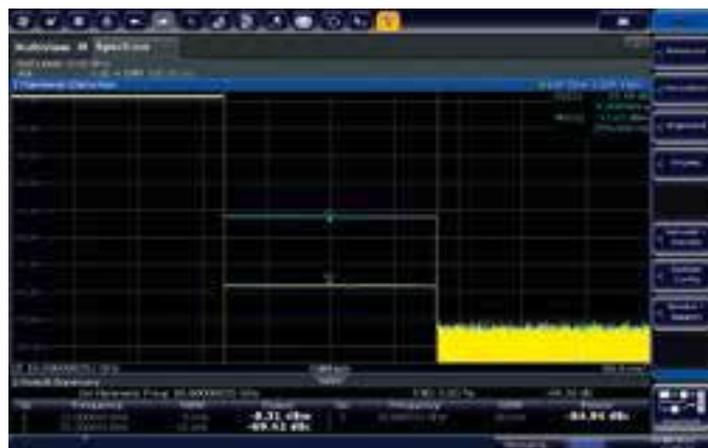
Сравнительный анализ гармоник усилителя (основная гармоника, первая и вторая гармоники), выполняемый с помощью прибора R&S®FSW. При включении внутреннего фильтра низших гармоник прибора R&S®SMB100A (желтый цвет) точность измерения может быть увеличена приблизительно на 25 дБ.
