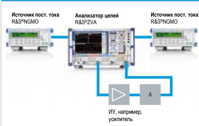
Измерительная установка состоит из векторного анализатора цепей R&S®ZVA для формирования двухтонального сигнала на порте 1 и отображения результатов измерения и двух источников постоянного тока R&S®NGMO для задания напряжений затвора и стока посредством внутренних сепараторов питания R&S®ZVA.
