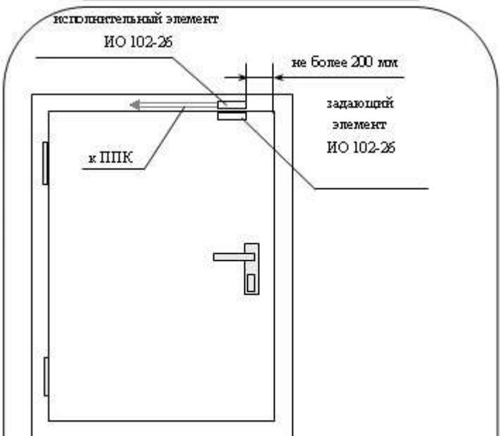
Рисунок 5. Пример установки извещателя для охраны
