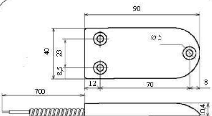
Рисунок 4. Габаритные и присоединительные размеры
