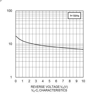
CAPACITANCE BETWEEN TERMINALS:C<sub>t</sub>(pF)
